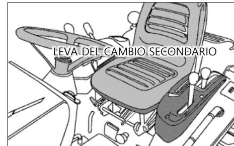
La leva del cambio di gamma viene utilizzata per selezionare la gamma di velocità del trattore.
