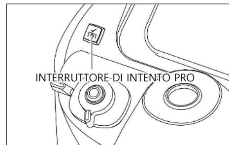
L'interruttore di intenzione PTO può controllare la rotazione dell'albero della PTO a condizione della posizione dell'operatore.
