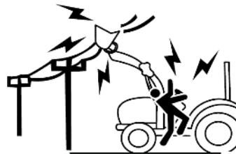
Evitare che i bracci o gli accessori del caricatore entrino in contatto con le linee elettriche. L'elettrocuzione causerà lesioni gravi o la morte.
