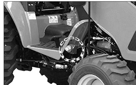
La funzione dell'interruttore di disconnessione della batteria è quella di scollegare l'alimentazione dall'impianto elettrico interrompendo il collegamento alla batteria.
