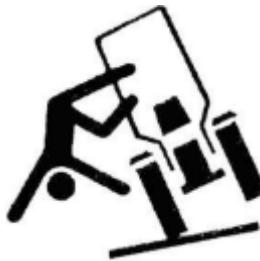
La struttura protettiva antiribaltamento (ROPS) è stata certificata secondo gli standard del settore e/o governativi. Qualsiasi danno o alterazione del ROPS, dell'hardware di montaggio o della cintura di sicurezza invalida la certificazione e ridurrà o eliminerà la protezione per l'operatore in caso di ribaltamento.
