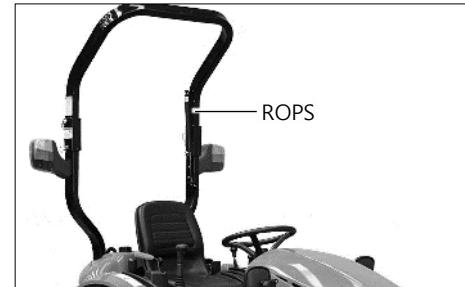
Il telaio di sicurezza è progettato per ridurre i danni causati da un incidente in caso di ribaltamento, quindi non può prevenire un incidente.
