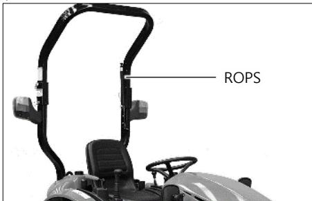
I trattori TYM sono dotati di un telaio per la protezione degli operatori. Nel caso dei trattori con cabina, il telaio è incorporato nella struttura della cabina. L'obiettivo del telaio o della struttura della cabina è proteggere l'operatore in caso di ribaltamento e in tal caso sono progettati per sostenere l'intero peso del trattore.
