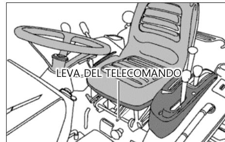
La valvola di controllo remoto idraulica può essere equipaggiata come opzione. La valvola viene utilizzata quando si collega l'attrezzo azionato da un cilindro idraulico.
