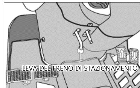
Con i pedali del freno sinistro e destro interbloccati, premete con decisione il pedale del freno con il piede destro e sollevate la leva del freno di stazionamento per bloccare i pedali.
